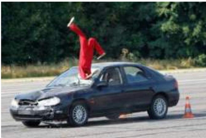
Crash-test relativo all'investimento di un pedone. Si noti come la testa del manichino abbia urtato contro il parabrezza, rompendolo. Osservate inoltre come il manichino si trovi letteralmente a testa in giù. Tale dinamica è caratteristica degli impatti a media-alta velocità.
