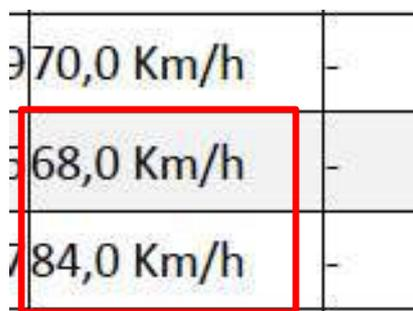
Estratto del report di crash completo, in cui prima dell'impatto contro il guard-rail viene registrato un incremento di velocità di 16 km/h del veicolo Smart in un intervallo di tempo di 1 secondo.
