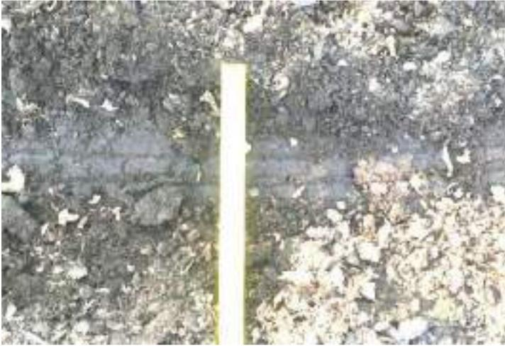
Traccia di pneumatico in frenata su una superficie fangosa. La frenata ha prodotto uno slittamento della ruota che ha cancellato i segni del battistrada lasciando solo i segni delle scanalature lungo la circonferenza.
