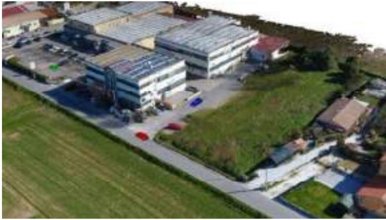
Nuvola di punti realizzata con tecniche di fotogrammetria 3D, applicate alle fotografie scattate da drone con l'ausilio di Pix4DCapture.
