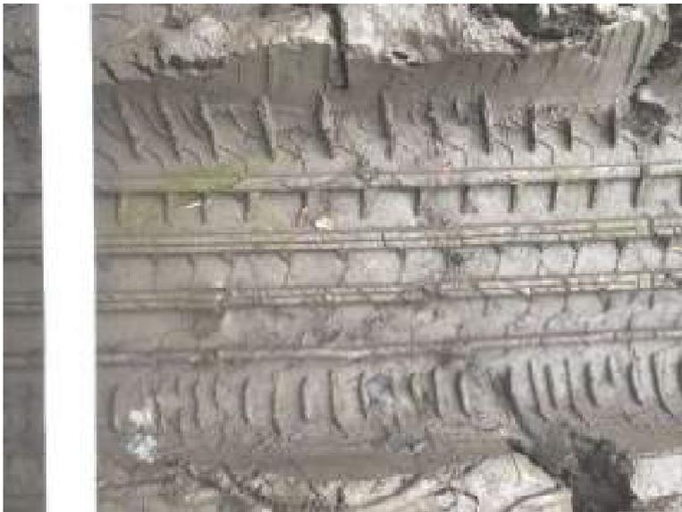
Uno pneumatico in transito sul fango morbido può lasciare un'impronta chiara e definita del battistrada. Una simile evenienza indica che lo pneumatico stava ruotando senza slittamento.
