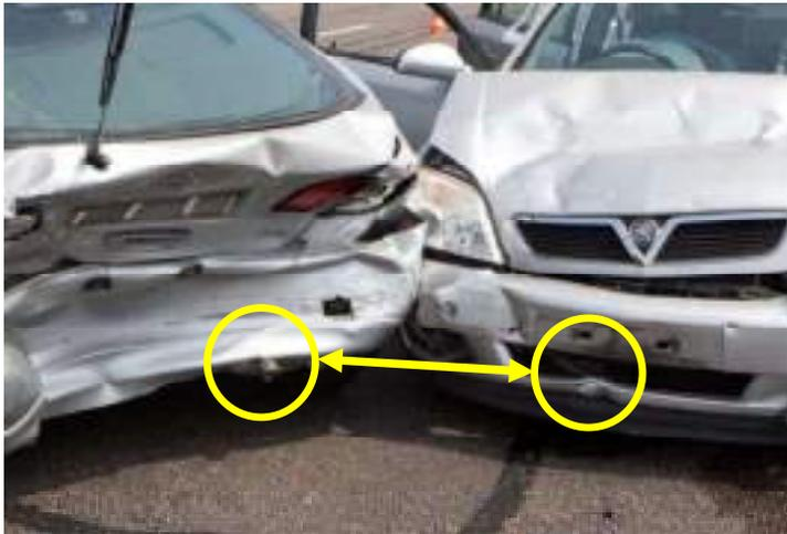
Il bordo inferiore del paraurti dell'auto a destra, presenta un segno impresso dal tubo di scarico dell'auto a sinistra. Questo particolare ci consente di collocare precisamente i veicoli al momento della collisione.
